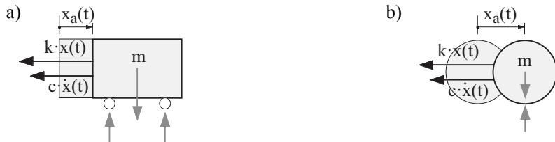
Figure 2.22: Forces agissant sur la masse pour un oscillateur simple soumis à une excitation à la base.
